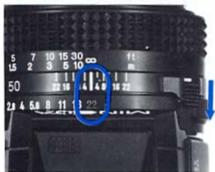
Objektiv auf kleinste Blende (grüne Zahl) einstellen und arretieren.
